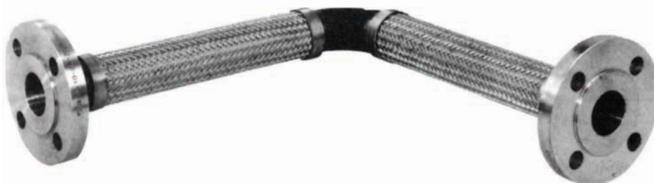
Úhlové vedení, hadice s 90° trubkovým obloukem, oba konce pevné příruba typ AE 204. Používá se hlavně u kompresorů k zachycování kmitání ze všech směrů.
