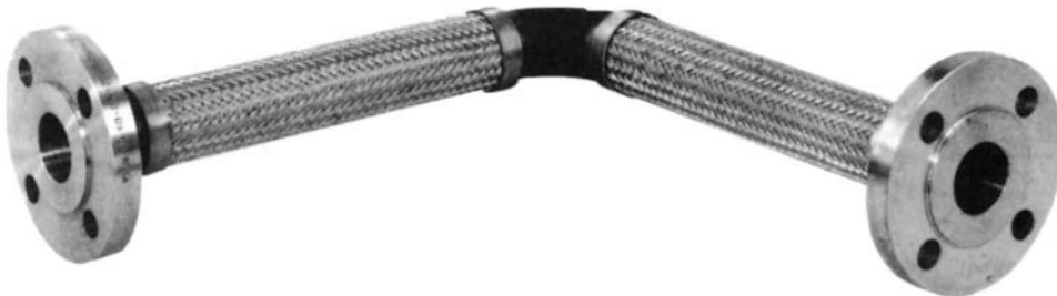
Rohová hadica s 90° kolenom, oba konce pevné príruby typ AE 204. Používa sa hlavne pri kompresoroch k zachytávaniu kmitania zo všetkých smerov.
