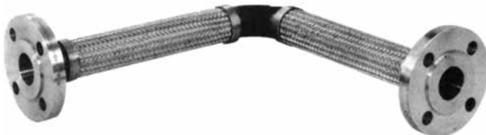
Rohová hadica s 90° kolenom, oba konce pevné príruby typ AE 204. Používa sa hlavne pri kompresoroch k zachytávaniu kmitania zo všetkých smerov.
